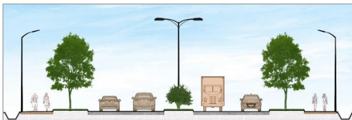
Keratan rentas tipikal bagi rizab jalan 30 meter (100 kaki) dalam Seksyen 51A
