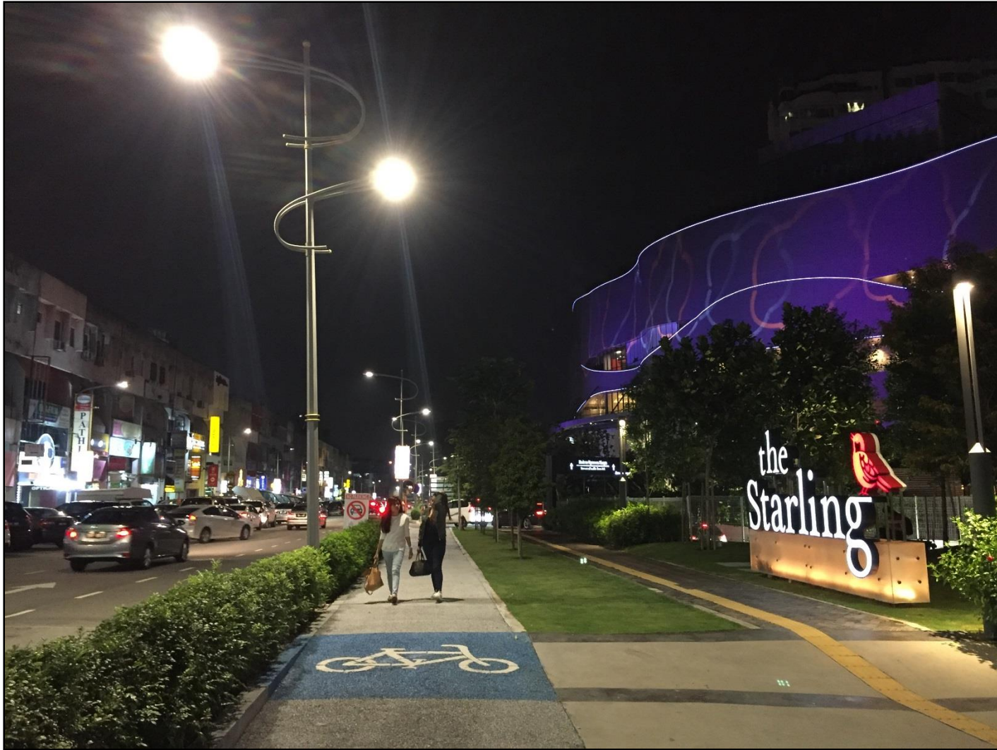
CONTOH REKABENTUK ELEMEN PENGASINGAN LALUAN PEJALAN KAKI DENGAN LALUAN BERMOTOR
